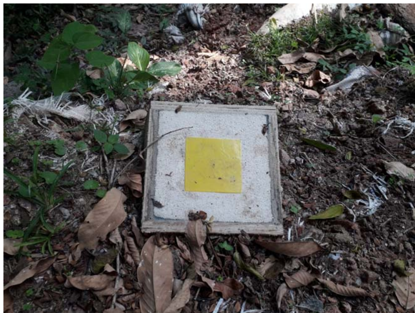
Figura 6.9- Marco superficial MS-50 na crista do talude.
