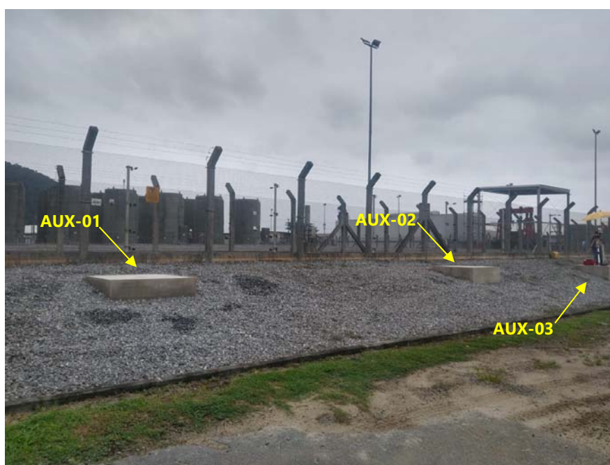
Figura 6.10 – Marcos auxiliares de apoio às leituras dos marcos superficiais da laje.
