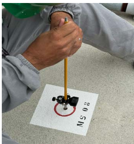
Figura 6.8 – Leitura do marco superficial MS-08 na laje da UAS.
