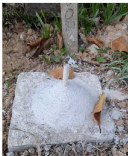
(b) Detalhe de um marco superficial típico- MS-02
